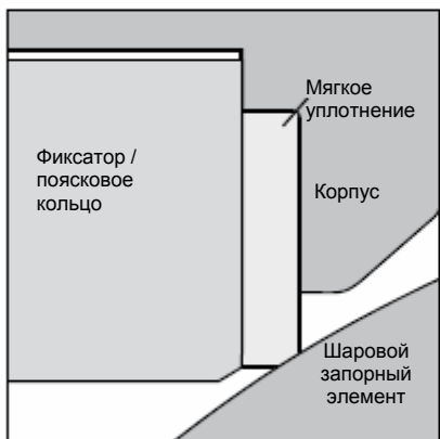
Рисунок 4: Мягкое уплотнение и поясковое кольцо
