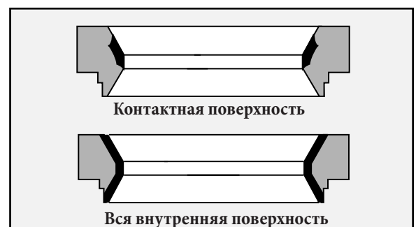
Рисунок 19: Варианты упрочнения поверхности седла
