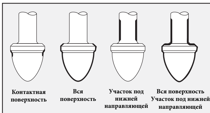
Рисунок 18: Варианты упрочнения поверхностей плунжера
