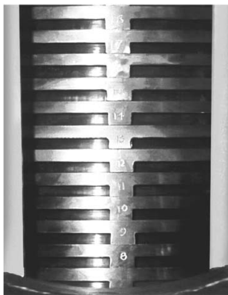
Рисунок 2: Положение пронумерованных дисков показывает правильность выравнивания опоры
